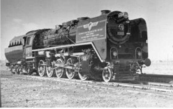
1915 Beygir Gücünde, 97 Ton ağırlığında 70 km/saat hız yapabilen ilk Türk Buharlı Lokomotifi
