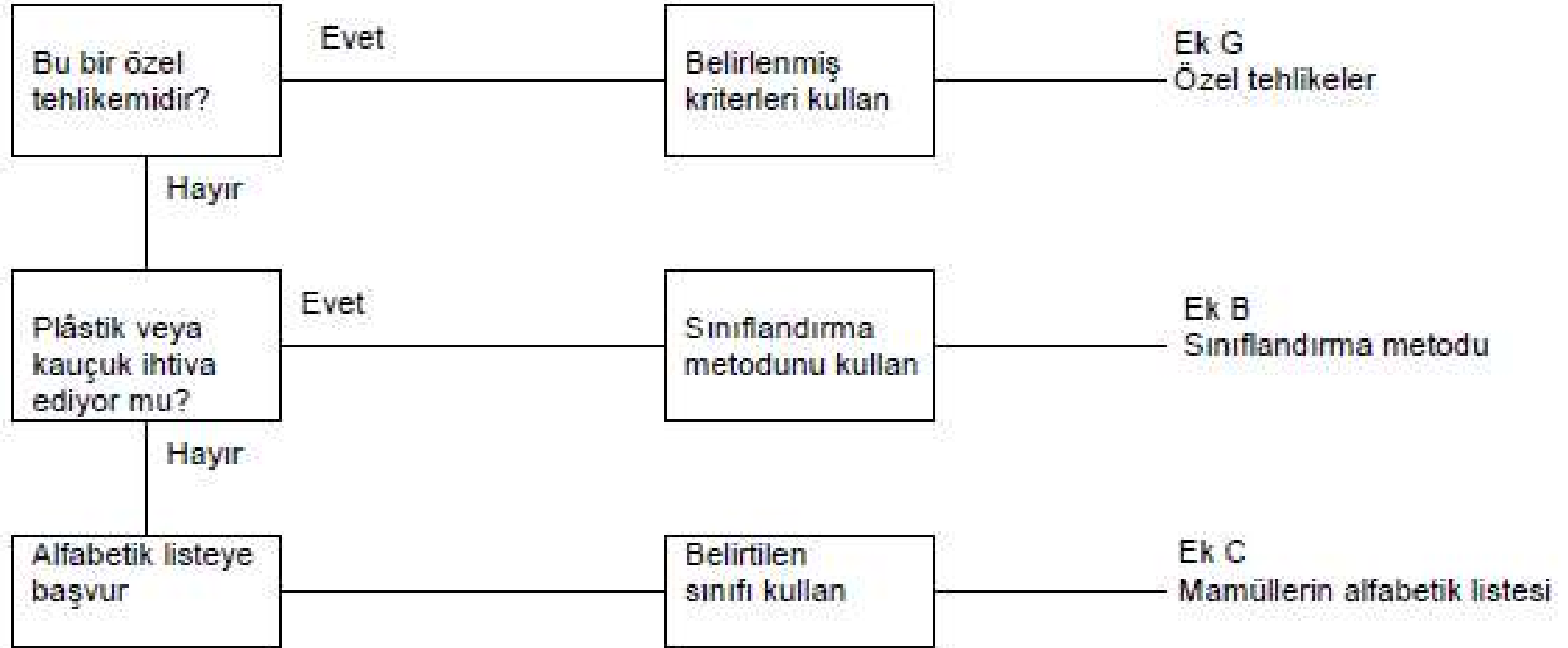
Şekil 2 - Depolama sınıfını belirlemede kullanılan akış şeması
