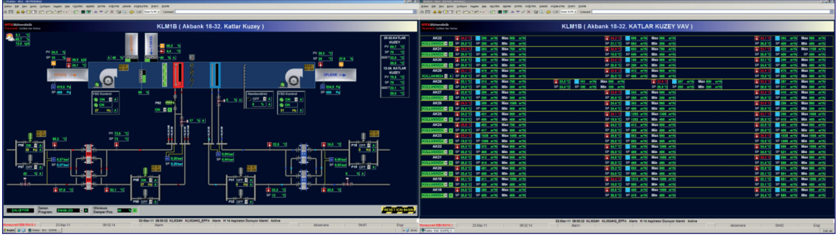
Resim 8. Sol Ekranda Klima Santrali ve Üst Köşede Statik Isıtma, Sağda Şartlandırılan Katlar
