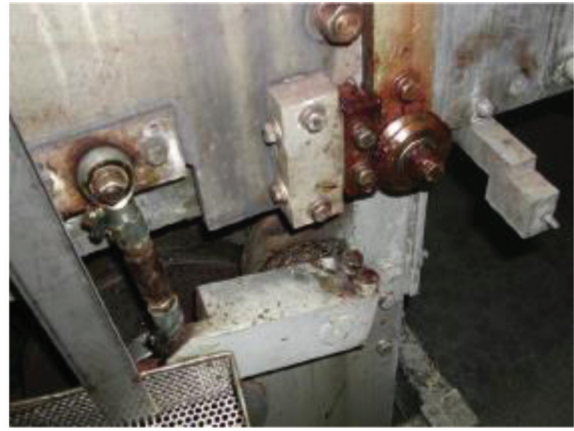
Şekil 6. Uygun Olmayan Bağlantı Elemanı ve Kaynak Çözümleri [5]
