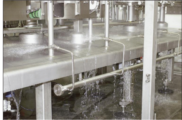
Şekil 8. Kendiliğinde Akışa Uygun Eğimli Yüzey [5]
