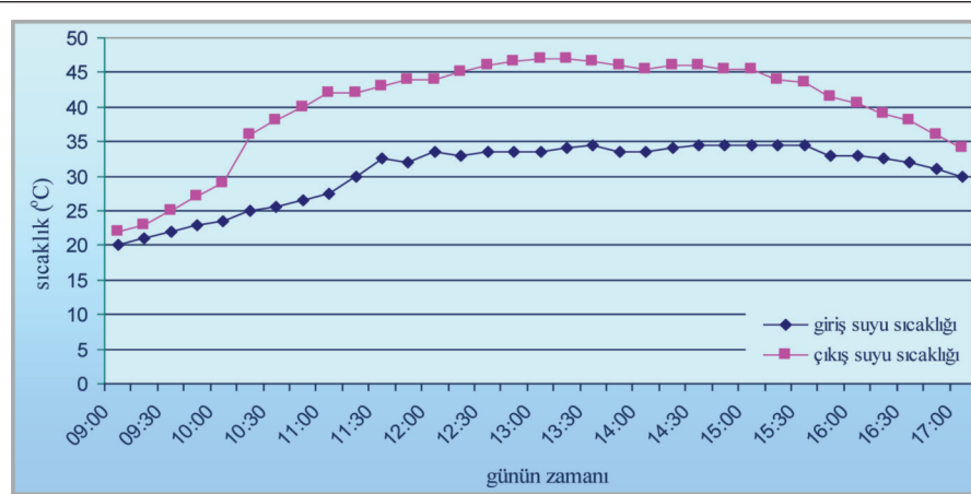
Şekil 7. Zamana Bağlı Olarak Sistem Akışkanının Giriş-Çıkış Su Sıcaklıkları İlişkisi
