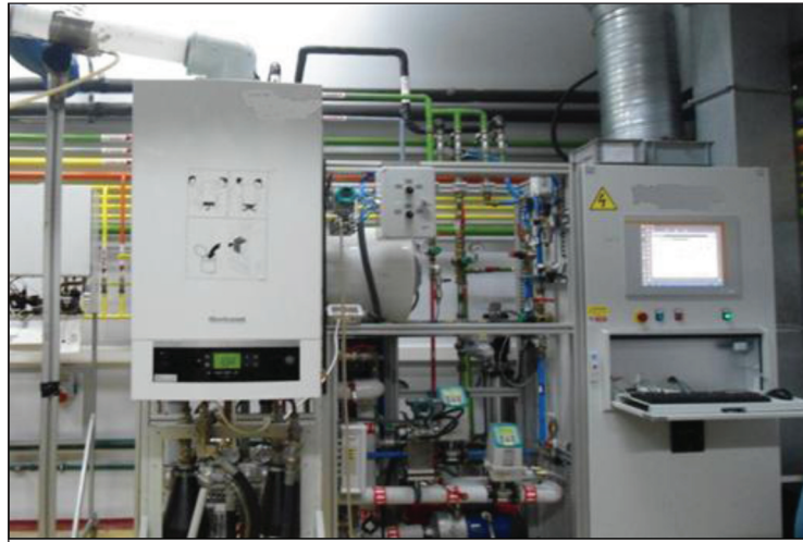
Şekil 17. Kombilerin Test Edilmesinde Kullanılan Test Cihazının Görünüşü
