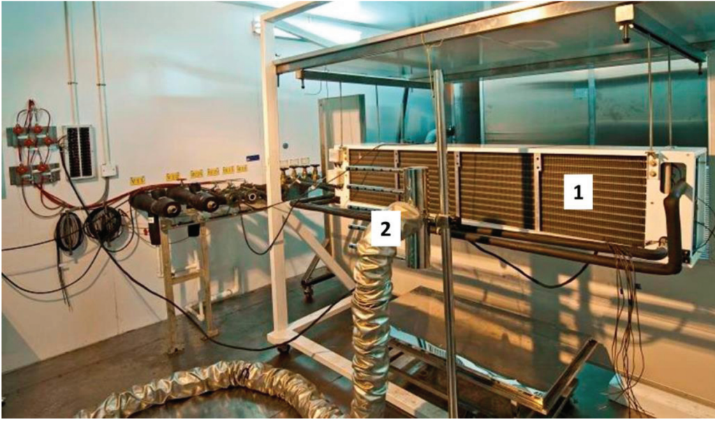
Şekil 3. Kalorimetrik Oda Örnek Test Görüntüsü (1. Test Edilen Ürün, 2. Hava Numune Alma Cihazı)
